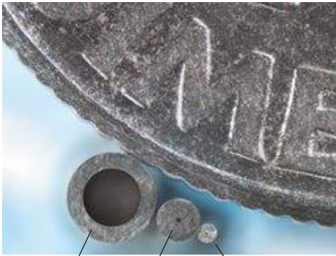
1/16" OD x .040" ID 1/32" OD x .004" ID 360 μm OD x .001" ID
